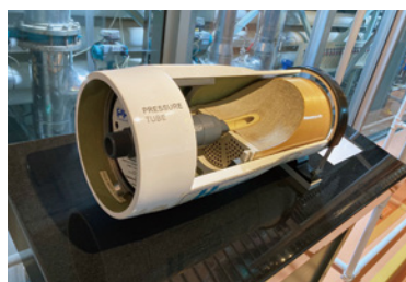
②逆浸透装置
