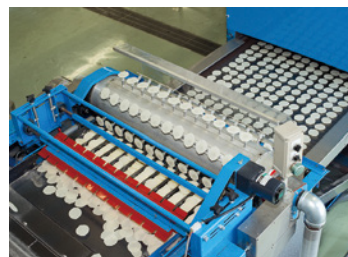
焼き機に入れる前に生地を整列させるための整列器
