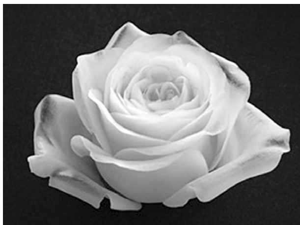
写真3 X線CTで取り込んだ3Dデータをプリントした例
