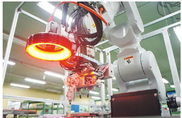
画像処理を利用したロボット組立システム
