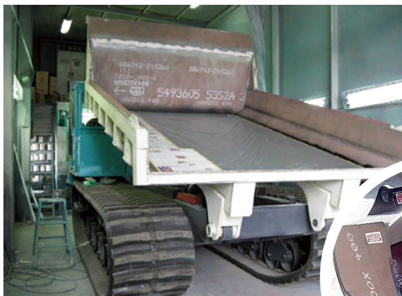
HARDOXが使われるトラックの荷台とバケット
