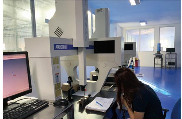
工場内の生産作業（写真左）と、三次元測定器で検査する現地スタッフ（写真右）
