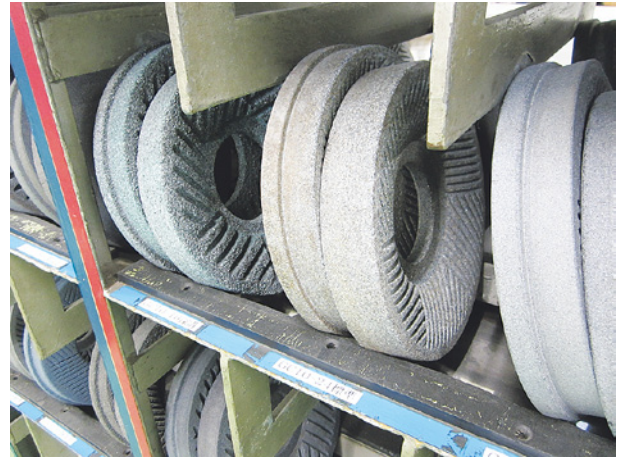
同社の命ともいえる砥石。磨砕後の粒子の大小、材料の種類・用途に応じた砥石が開発されている。
