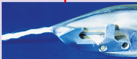
↑ 確実に糸をつかむレピアの拡大写真
