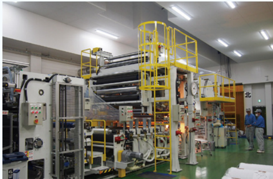
2018年に導入したコーティングと熱ラミネートの兼用加工ライン
