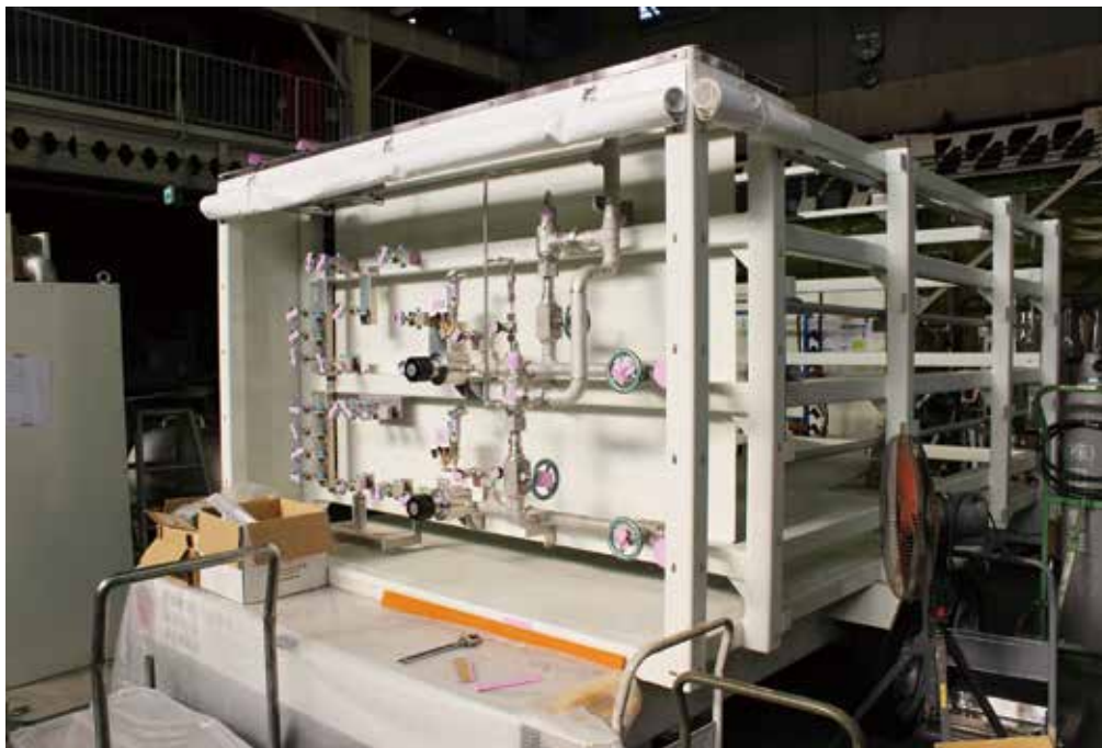
蓄圧器ユニット
