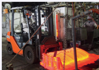
溶体化処理（各種材料を水冷する）
