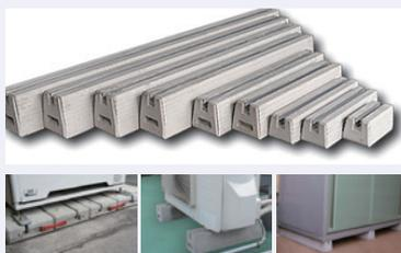
『スライドブロック』は、エアコン室外機など屋外設置される機器のベースとしてご利用いただけます。また、樹脂製ベースと比較して耐候性や強度面などに優れており、埋設したアルミレールはM10およびM12のボルト両サイズに対応しています。
