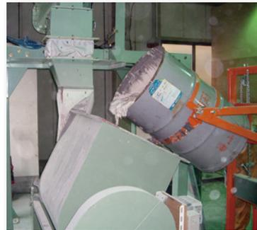
実際の固化している場面です。機械を稼働し安定固化剤『ジェット-P』を混入します。
