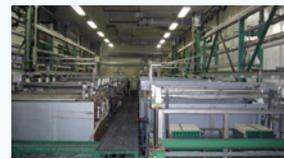
指定された無電解金めっき膜厚をプログラム制御により管理し、フレキシブル基板から高多層基板まで安定した品質でめっきを行う。
