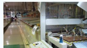
極薄板厚基板やBVH基板など製品の特性に応じたプレーティングプロセスが組めるツーラック方式により、安定した品質と作業の自動化に対応する。
