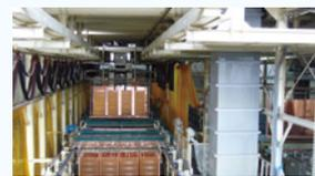
前処理から電気めっきまで連続するワンラック方式のめっき装置によりキズやムラが抑えられ、多品種少量品や大型基板などの特殊サイズ品にも高品質&スピード量産に対応する。
