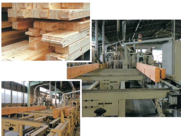
コンピューター制御された機械を用いて「プレカット工法」をいち早く取り入れ、加工精度・施工精度を図りながらコストダウンと高品質材の安定供給を実現
