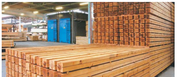
熱源に木屑等を利用して環境にも配慮した全13基の乾燥庫
