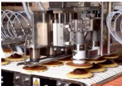
自動どら焼機の焼印・合わせ工程
