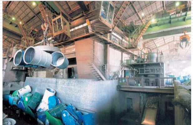
厚みや長さのある母材を一定の長さにするため圧縮しながら切断（シャーリング）加工する大型設備。通称「ギロチン」と呼ばれている。
