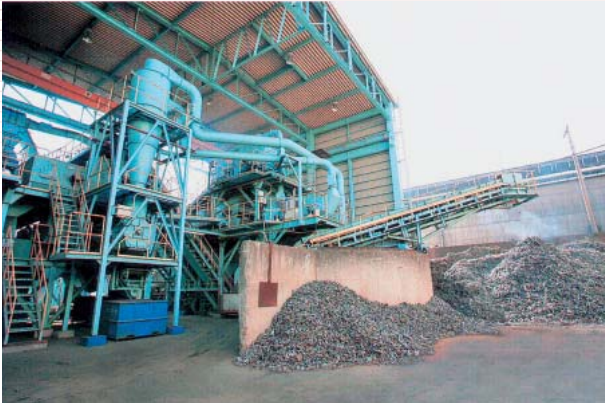
持込まれた鉄スクラップを鉄・非鉄金属・非金属に分別するため、高速回転する円筒形のドラムに取り付けられたハンマーで細かく破碎（シュレッター）加工する大型設備
