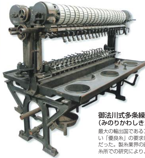
御法川式多条繰糸機(部分)
